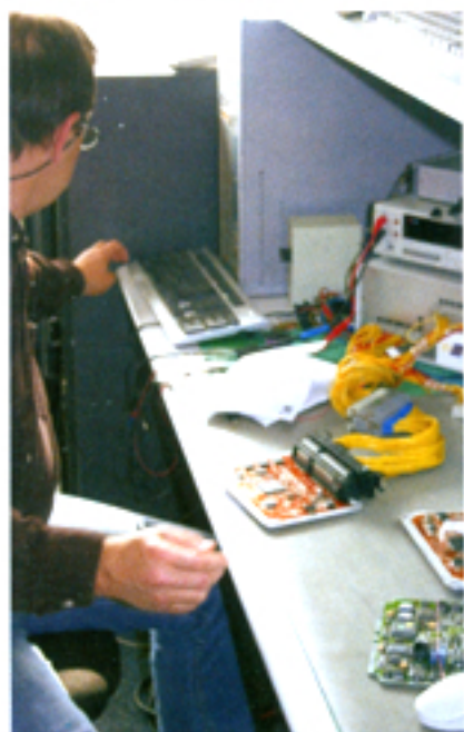
Die Steuergeräte werden vorab diagnostiziert, um eine Aussage treffen zu können, ob eine Reparatur Sinn macht.
